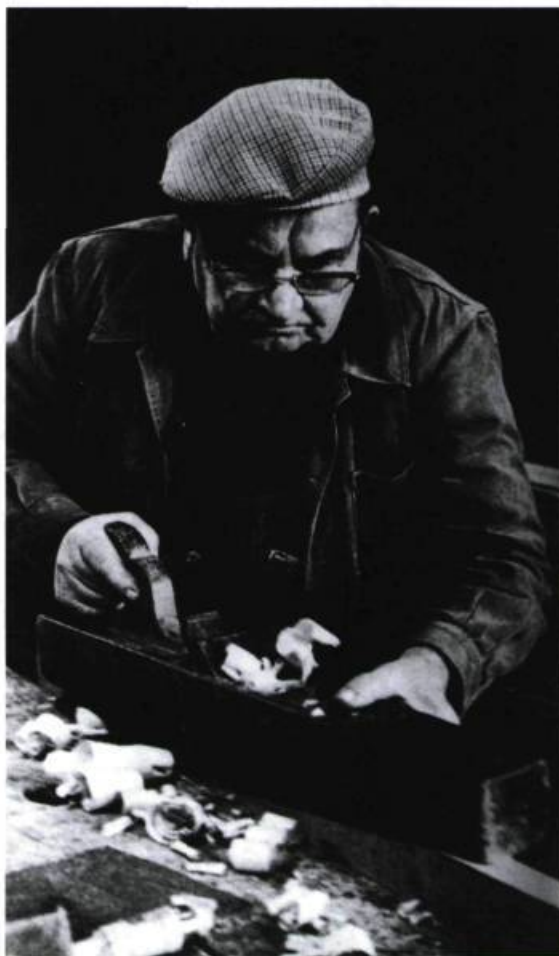
La varlope guidée par un menuisier pour corroyer le bois, l'aplanir et le mettre d'épaisseur. Photo tirée du Livre de l'outil , tome I, Paris, Hier et Demain, 1976.
