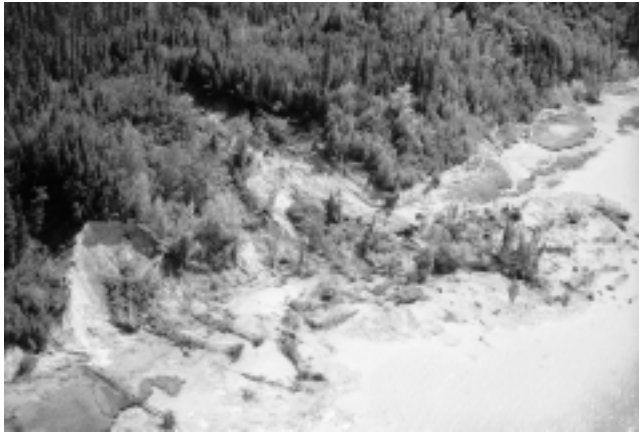
FIGURE 2. Accumulation de débris au pied de la berge résultant de glissements de terrain (rive droite de la rivière Broadback).
