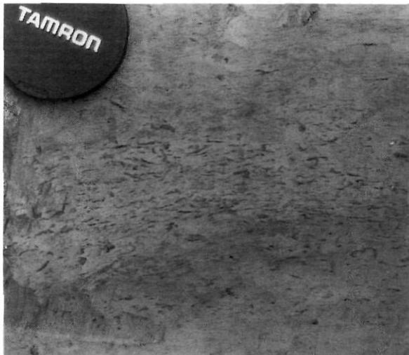
FIGURE 17. Sulfures dans la partie inférieure massive de l'Argile de La Pérade (unité C', coupe 53-A). Saint-Pierre-les-Becquets.
