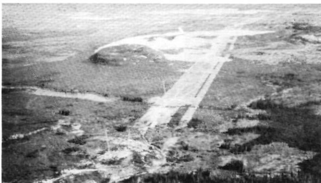
FIGURE 5. Vue aérienne montrant un épandage subaquatique recoupé par la ligne de transport d'énergie hydro-électrique en provenance de LG-2. Ce dépôt a fourni les matériaux pour la construction du barrage sur la petite rivière Opinaca située à l'arrière plan. Lat. 52°22' N, long. 76°45' O. Vue vers le NNO.
