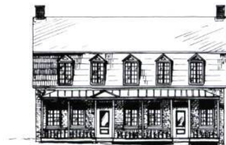
Résidence à toit mansardé dont la pierre est à nu mais la toiture et l'auvent sont revêtus suivant trois procédés différents.
