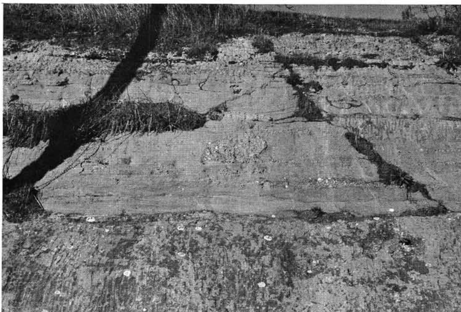
Photo 7 Route Peralillo à Marchihue. Croûte illuviale litée et poches de pierres ponce. Le secteur non consolidé est à la base plus foncé parce que gorgé d'eau. Hauteur de la coupe : 4 mètres environ.
