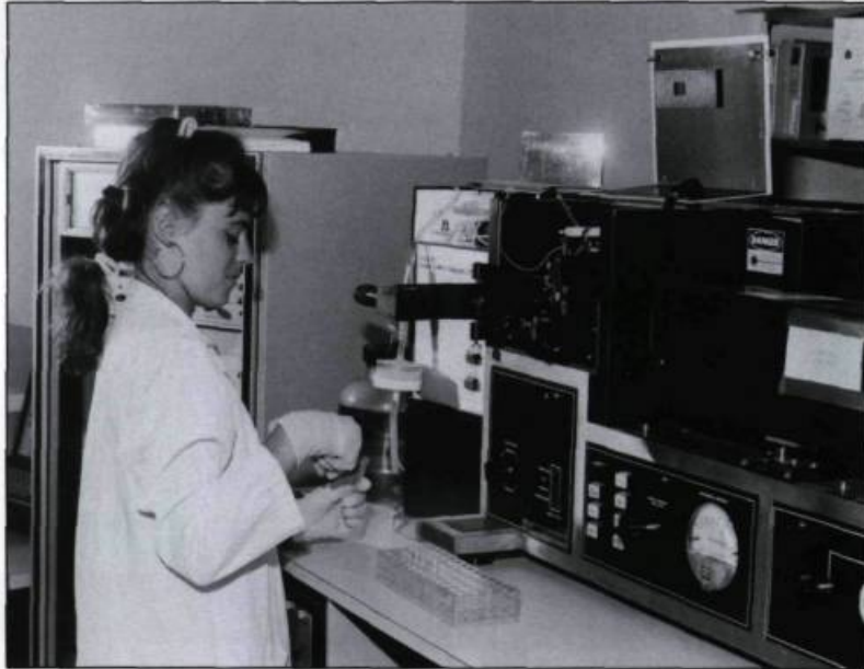
Le cytofluoromètre aide à détecter et à connaître la nature et l'état de développement des cancers. (Photographie médicale, Hôtel-Dieu de Québec).
