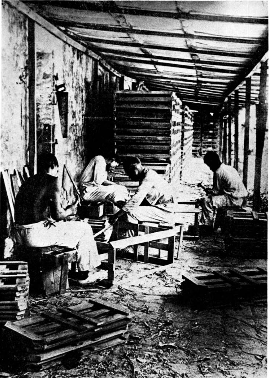
1929. — Sous l'appentis longeant le Grand Hall - Montage des caisses (doubles et triples)... Elles seront ensuite numérotées au pochoir, puis transférées dans le Hall. Les planchettes (tringles) vinrent d'abord de Deshayes (par canot). Elles étaient de « Poirier » de la forêt de Deshaies. Les fonds des caisses étaient montés dans les ateliers du Fort Richepanse. Par la suite, à partir de 1928, tringles et fonds (montés) furent principalement fournis par Maurice Brugère qui avait alors créé une exploitation forestière dans les forêts du Matouba et une scierie-atelier à Planel.
