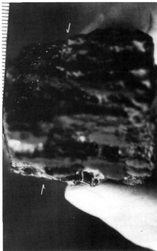
FIGURE 9. Faille normale à 140 cm de profondeur dans le sondage latéral. Photographie: G. Seret. Normal fault at 140 cm in the side hole. Photo: G. Seret.
