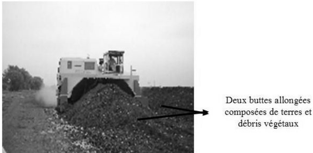
Figure 3. Retournement d'un andin vue de face (Site Total, Vendin-LeVieil, Nord-Pas-de-Calais)
