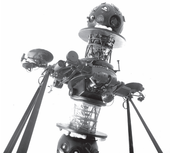
Figure 3. Planétaire Zeiss : Planétaire Zeiss Mark V, installé en 1966 dans le théâtre des étoiles du Planétarium Dow de Montréal. Planétarium Rio Tinto Alcan/Espace pour la vie.
