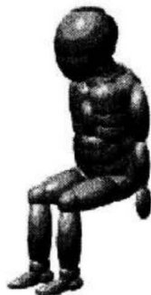
FIGURE 1 MANNEQUIN HYBRID III-3 ANS (D'APRÈS TNO AUTOMOTIVE, 2003A)
