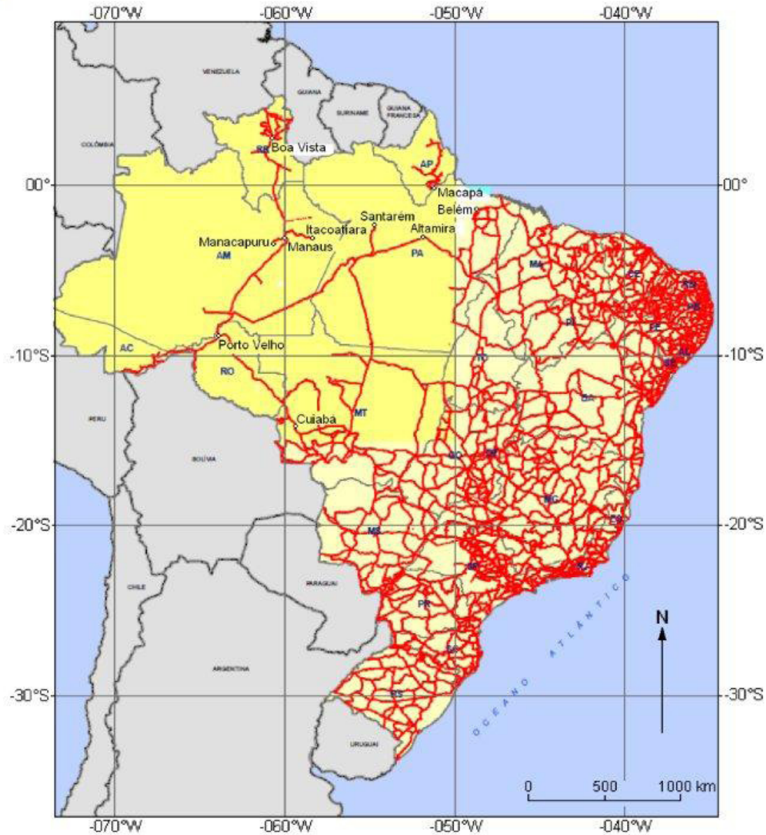
Figure 1. Les mailles de nivellement de précision au Brésil (document IBGE). The mesh of precision levelling in Brazil (IBGE document).
