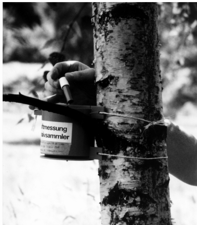
FIGURE 3. Matériel pour l'échantillonnage passif des polluants gazeux. A) Cinq tubes de prélèvement (trois pour l'ozone et deux pour le dioxyde d'azote) sont insérés dans un réceptacle. B) Les réceptacles sont fixés aux arbres.
