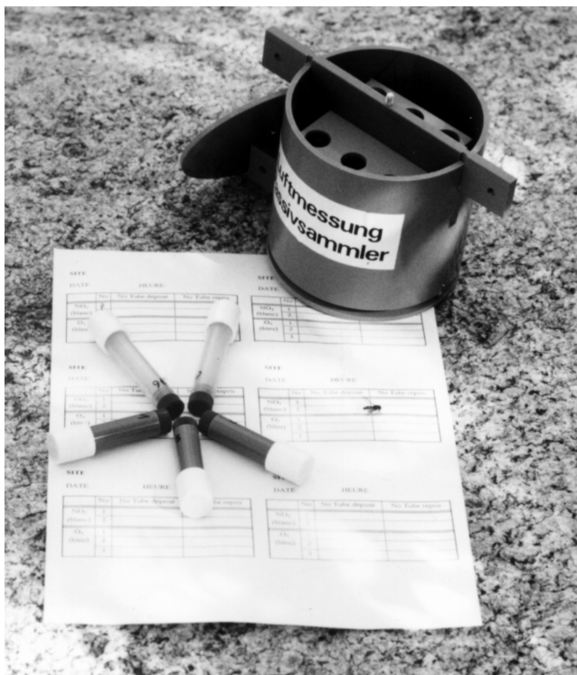
FIGURE 3. Matériel pour l'échantillonnage passif des polluants gazeux. A) Cinq tubes de prélèvement (trois pour l'ozone et deux pour le dioxyde d'azote) sont insérés dans un réceptacle. B) Les réceptacles sont fixés aux arbres.
