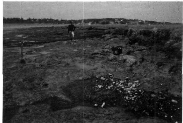
FIGURE 15. Recul rapide du schorre supérieur dans la zone B, à Rivière-du-Loup, en 1985-86. Le piquet métallique placé le 30 octobre 1985 indique un recul de 530 cm en 9 mois (86.7.24).
