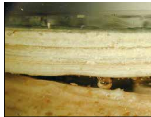
Coupe stratigraphique des 28 couches de badigeon de chaux.
