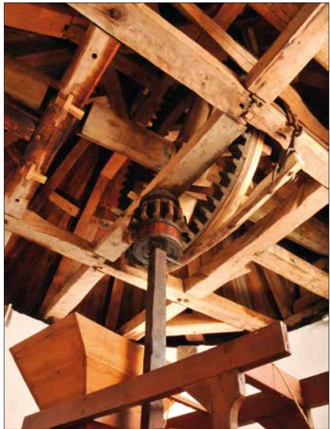
Les composantes originales du mécanisme ont été préservées ou reconstituées. Le moulin à vent de L'Isle-aux-Coudres est donc l'un des seuls au monde à fonctionner selon les principes du XVIII e siècle.
