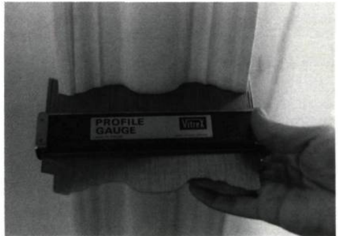
5. Le gabarit à moulures employé pour relever et reproduire fidèlement le profil d'une moulure. (photo: F. Varin)
