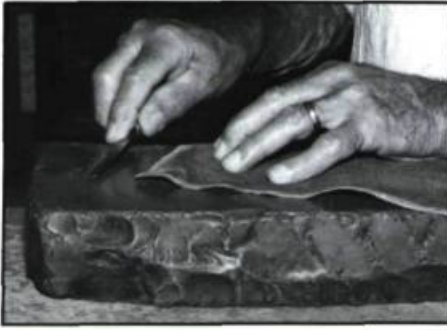
6 Amincis- sage ou pa- rage du cuir pour en fa- ciliter le collage sur le dos du volume.
